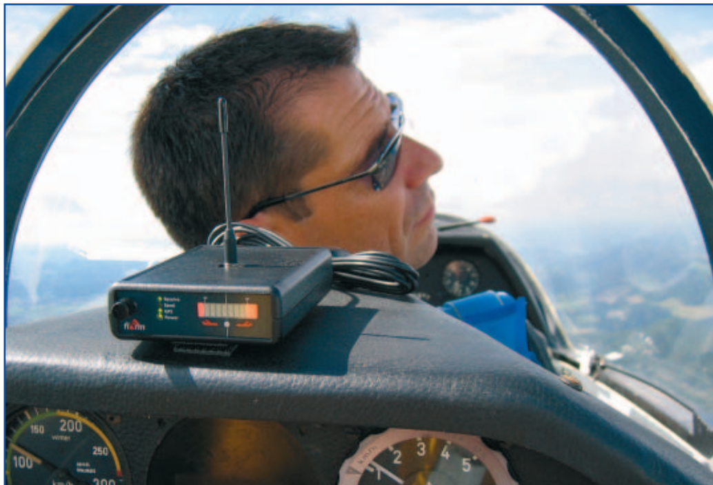
FLARM passt aufs Instrumentenbrett und liegt im Blickfeld. Die GPS-Antenne hat einen eigenen Platz.
